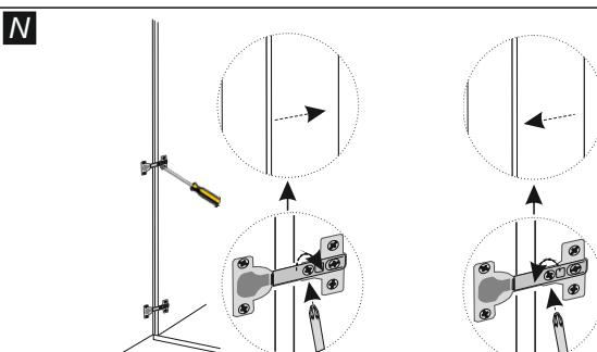
Se l'apertura/chiusura delle ante non è perfetta, è necessario agire con il cacciavite sulla vite posta al centro delle cerniere, avvitando e/o svitando leggermente. In relazione al senso di rotazione della vite sulla cerniera, l'anta si avvicina o allontana dal fianco del mobile.
