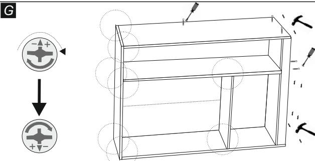
Ruotare gli eccentrici (30) posizionati sui fianchi e sulle tramezze (4 e 7), in senso orario. Con le viti 7x50 (35): fissare la base (8) al fianco dx (2) ed alla tramezza (4), ed il tirante (10) posto dietro alla schiena (14). Inserire i piedini (23) in fondo ai fianchi ed agli zoccoli (9).
