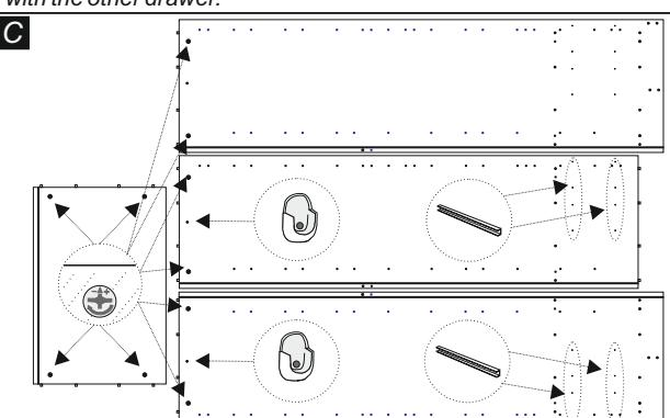
Inserire gli eccentrici (30) negli appositi fori posti sui fianchi (2, 3) e sulle tramezze (4, 7), con la freccia rivolta verso il bordo superiore come da figura. Fissare i reggitubi (24) e le guide cassetto (28) sui fianchi con le viti 3,5x16 (26). Insert the cams (30) in the appropriate holes on the sides (2, 3) and on partitions (4, 7), with the arrow pointing toward the top edge as shown in figure. Fix the bar holder (24) and drawer runners (28) on sides with the screws 3,5x16 (26).
