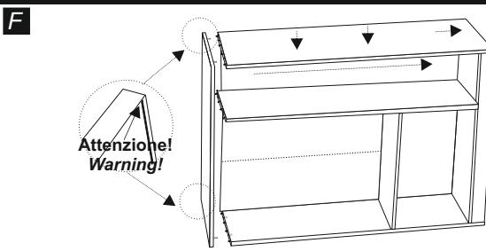
Inserire la schiena (14) con il lato colorato rivolto verso l'interno del mobile, facendole scorrere nelle apposite guide poste sulla tramezza (4). Mettere il fianco dx (2) sopra telaio e chiudere con il coperchio (1), infilandolo lateralmente sui fianchi con i perni (31) inseriti precedentemente. **Attenzione: non rompere i bordi alle estremità della fresa.**
