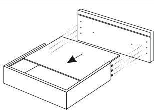
Distendere su un piano il davanti cassetto (15) e la sponda cassetto (16), ed applicare la colla (22). Chiudere la sponda sul fondo cassetto (17) con il lato colorato verso l'interno del cassetto, ed inserire i fianchi della sponda nel davanti. Ripetere l'operazione per l'altro cassetto.
