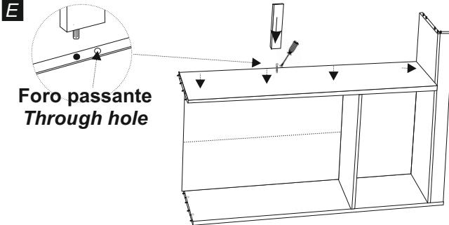
Mettere la tramezza verticale (4) sopra telaio. Fissare il tirante (11) con la vite 7x50 (35). Inserire quindi sopra la tramezza il tirante (10).
