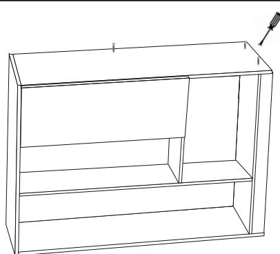
Girare il mobile sull'altro fianco e ripetere le operazioni descritte al punto H, per: fissare le ante dx (5 e 6). Fissare la base (8) ed il tirante (11) al fianco sx (3) con le viti 7x50 (35).
