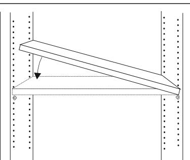
Inserire i cassetti nel mobile assemblato. Inserire la barra portabiti (25) sui reggilibi (24). Inserire i ripiani inclinati (18 e 19) sui reggipiani (29) inseriti precedentemente sui fianchi e tramezza, quindi riportare in posizione orizzontale i ripiani.
