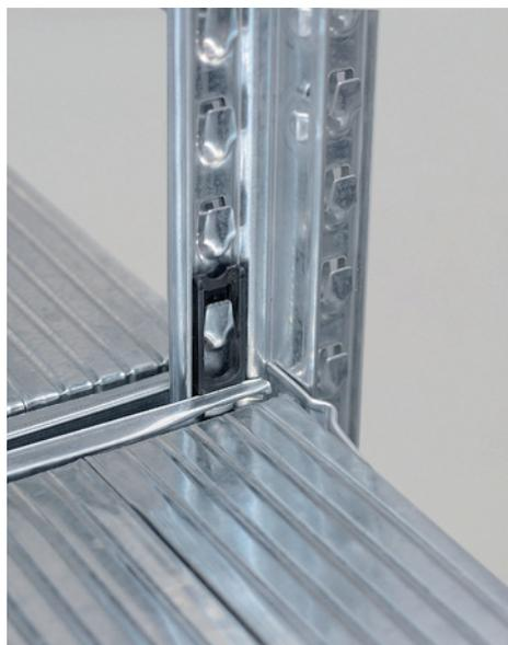
Antisgancio in PVC: adatto al solo impiego sui correnti interni di campate bifronte. Installare manualmente sul dente di connessione appena sopra al corrente.
