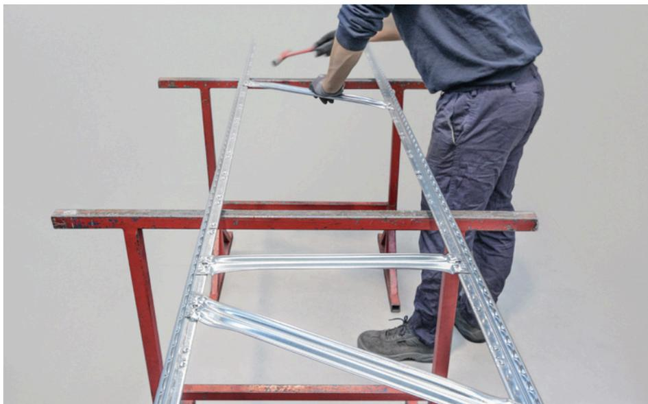
Completare l'installazione di tutti i componenti del primo lato della spalla seguendo le prescrizioni del Manuale Tecnico Super 1-2-3 (MT08).
