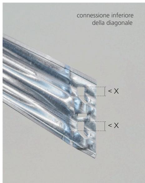
Si noti la differenza geometrica tra i fori di connessione alle due estremità della diagonale. Le forature all'estremità superiore sono più lunghe per fungere da guide e agevolare l'installazione secondo la corretta inclinazione.
