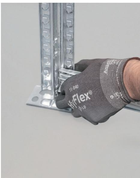
Installare i correnti sull'interno delle spalle iniziando dal lato posteriore della campata. Far aderire gli agganci di un'estremità del corrente sui denti del montante posizionando inizialmente il corrente con una lieve inclinazione e poi premendolo in posizione come mostrato in figura.
