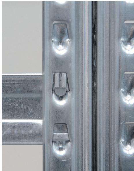
Fissare in posizione l'antisgancio con l'ausilio del martello gommato, battendolo fino a farlo scattare nella posizione indicata in figura.
