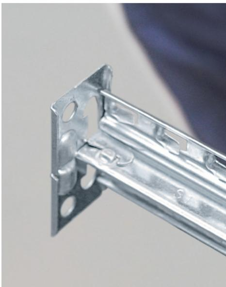
Installare al piede di ciascun montante della spalla una basetta metallica, posizionandola dapprima manualmente come mostrato in figura e completando poi il fissaggio servendosi del martello gommato.
