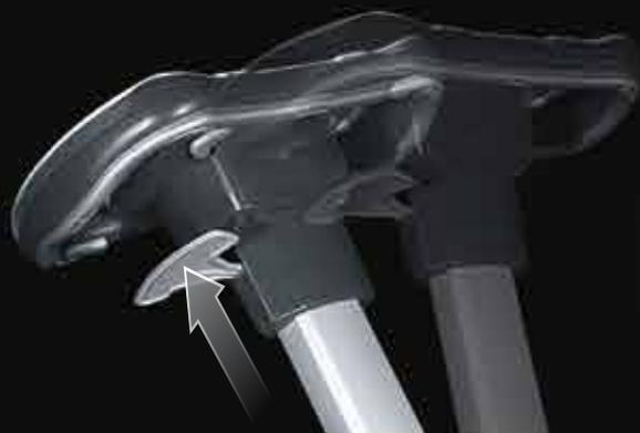
L'altezza e l'inclinazione del volante si possono adattare secondo la statura dell'operatore, per non affaticare la schiena.
